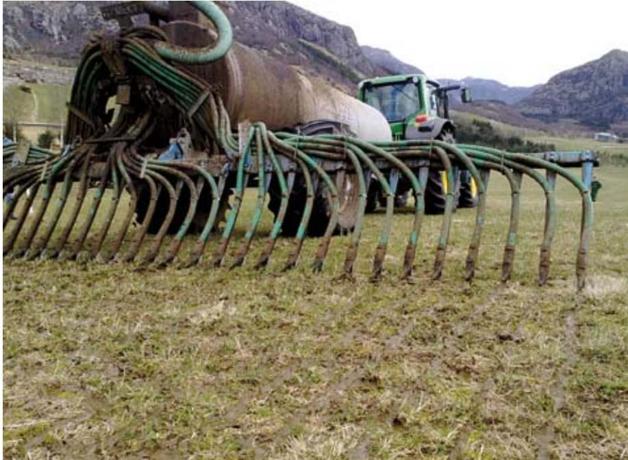
Bomech nedfellar. Det vart nytta om lag 3 tonn blautgjødsl per daa om våren, og om lag 2 tonn blautgjødsl per daa etter 1. siloslått. Det er ikkje nytta mineralgjødsl i tillegg til husdyrgjødsla. Foto: Eirik Sunde.
