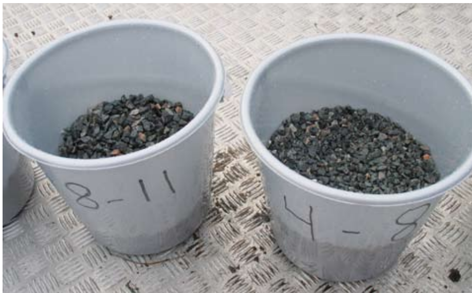
Bøtter med grove filtertypar (8-11mm og 4-8mm). Foto: B.J. Øpstad
