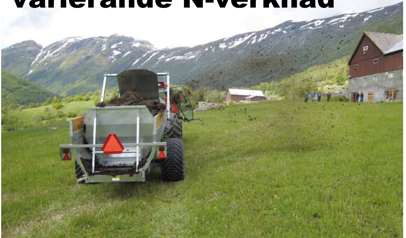
Med fastgjødslingspreiaren GAFNER vert det jamn spreieing i 7 m ut til eine sida i flatt terreng. Foto: Jan- Erik Mæhlum
